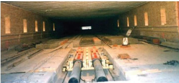
**Figura 1.10.** Interior del horno túnel Gaudí instalado en la empresa española Ceranor S.A [8]
