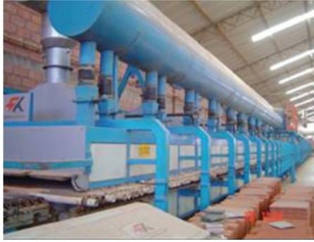
**Figura 6.25.** Horno de rodillos existente en el área metropolitana de Cúcuta. Cortesía de Cerámica Andina.
