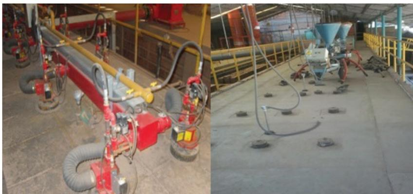
**Figura 6.24.** Sistemas implementados en los hornos Túnel de la región para la dosificación de combustible. Cortesía de Cerámica Andina (Izquierda) y de Ladrillera Merkgres(Derecha).
