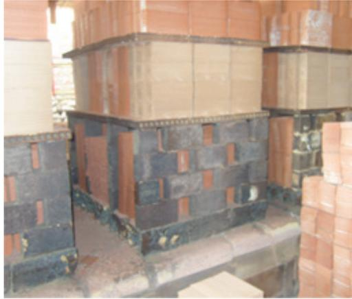
**Figura 6.34.** Acomodamiento de material de revestimiento en un horno túnel. Cortesía Cerámica Andina
