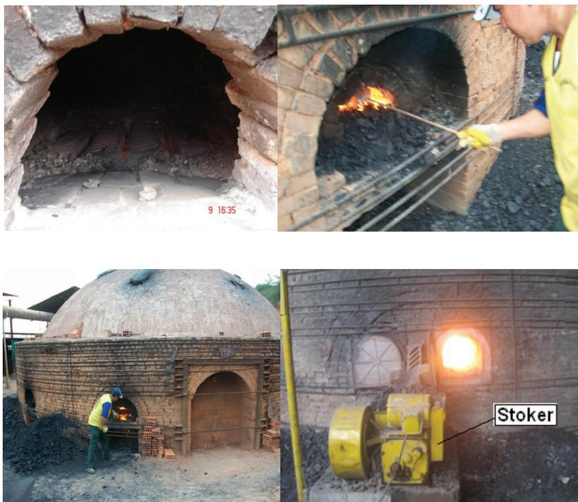
**Figura 6.7.** Hornillas del horno colmena. Foto cortesía del Cimac-UFPS.
