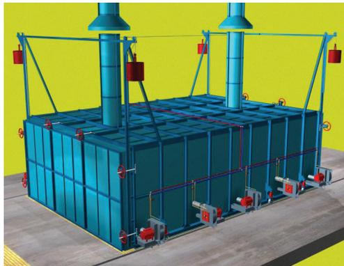
**Figura 4.8.** Horno de zona móvil de cocción <sup>[7]</sup>
