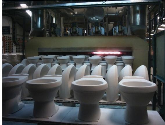
**Figura 2.9.** Horno de transferencia utilizado en la industria cerámica <sup>[13]</sup>.
