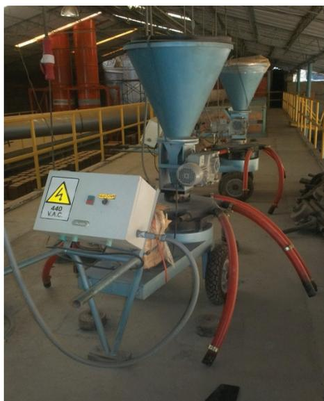
**Figura 6.21.** Carbojet utilizado para la dosificación de carbón en los hornos cerámicos de la zona metropolitana de Cúcuta. Cortesía Ladrillera Merkagres de Colombia
