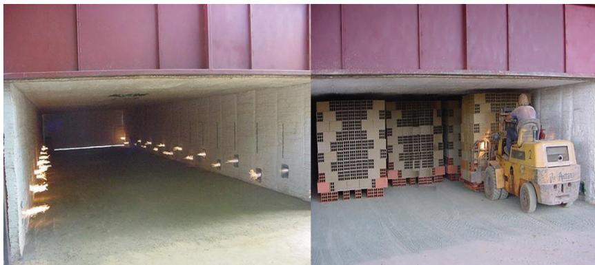
**Figura 2.7.** Horno fijo para la industria alfarera con capacidad de 30 000 bloques/quema (Cortesía de la empresa Combustion Service S.A)<sup>[10]</sup>.
