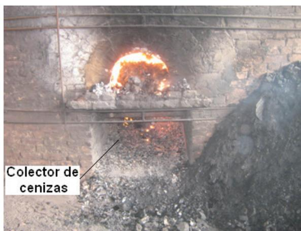
**Figura 6.10.** Colector de hornilla del horno colmena.
