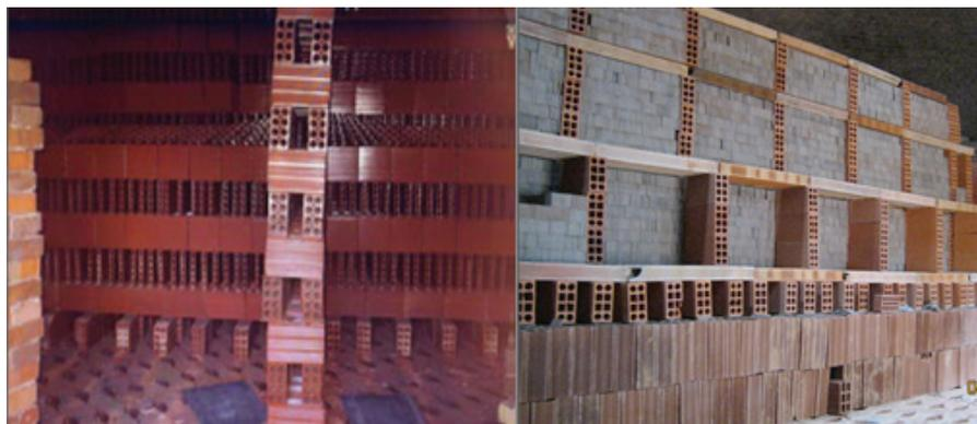
**Figura 6.32.** Acomodamiento del material para la cocción de pisos y enchapes en un horno colmena. Foto cortesía del CIMAC-UFPS.
