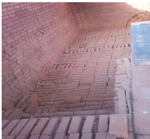
**Figura 6.33.** Acomodamiento de ladrillo en el horno pampa y fuego dormido. Foto cortesía del CIMAC-UFPS.
