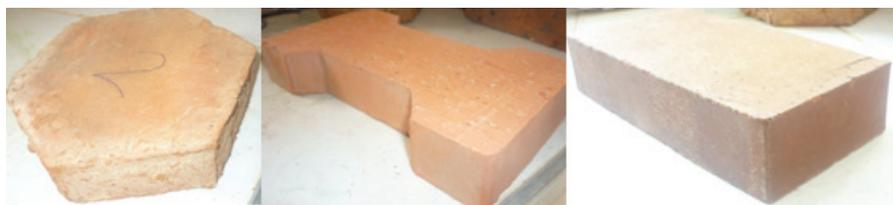
**Figura 6.28.** Piezas cerámicas para pavimento fabricadas en la zona metropolitana de Cúcuta
