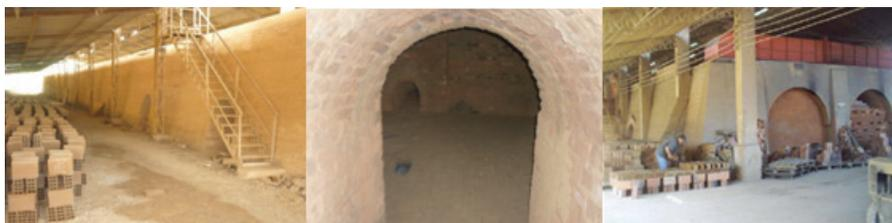
**Figura 6.19.** Registro fotográfico de la parte exterior de un Hoffman túnel existente en la zona metropolitana de Cúcuta. Foto cortesía del Cimac-UFPS.
