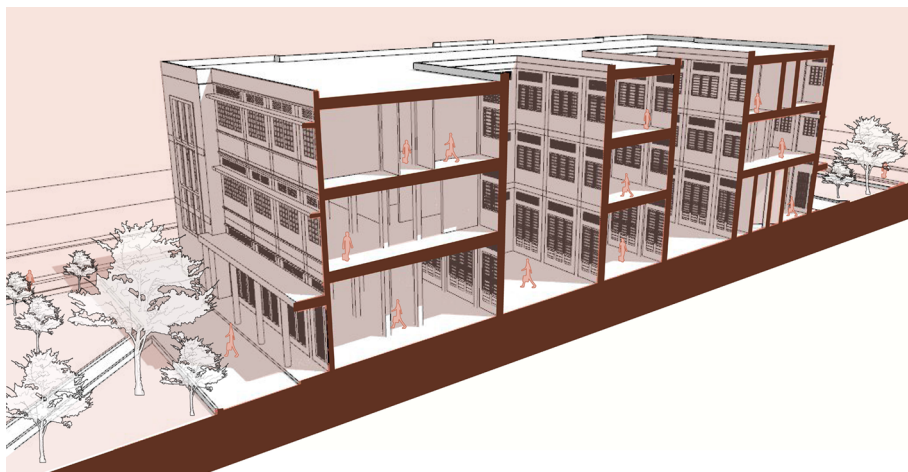
Figura 39. Corte axonométrico longitudinal del Edificio Santander
