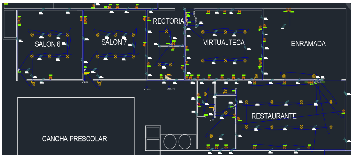
Figura 23. Plano eléctrico del primer piso trazado en AutoCAD
