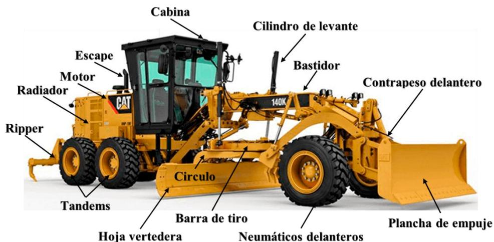
*Figura 13. Principales componentes de una motoniveladora.*
