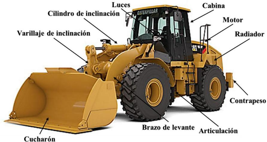
*Figura 7. Principales componentes del cargador frontal.*
