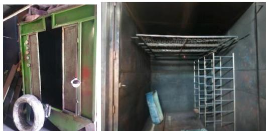
**Figura 12.** Cabina de pintura y horno de cocción
