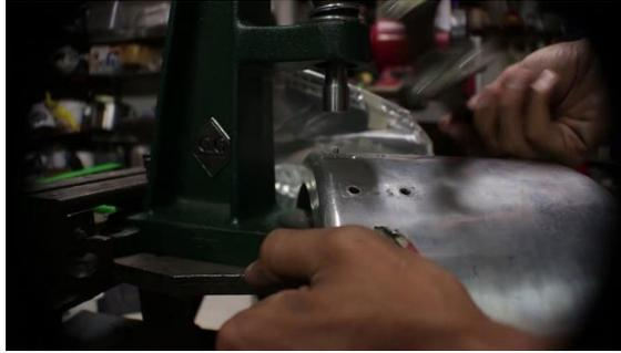
**Figura 3.** Uso remachadora ollas a presión
